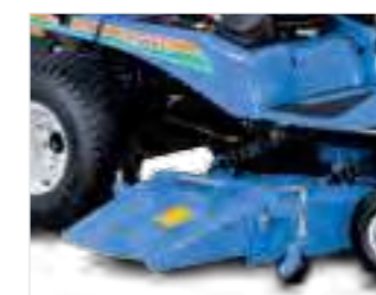
Plateau ventral à éjection latérale 1,52 m ou 1,83 m Kit mulching en option
