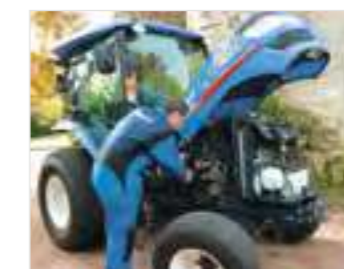
Entretien facilité ISEKI a conçu la gamme TG6 avec un capot monobloc monté sur vérins à gaz et des joues latérales amovibles qui donnent plein accès au moteur. Tous les éléments qui requièrent des contrôles sont faciles d'accès pour un entretien simplifié
