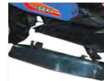
Carter latéral blocable en position relevée et démontable facilement
