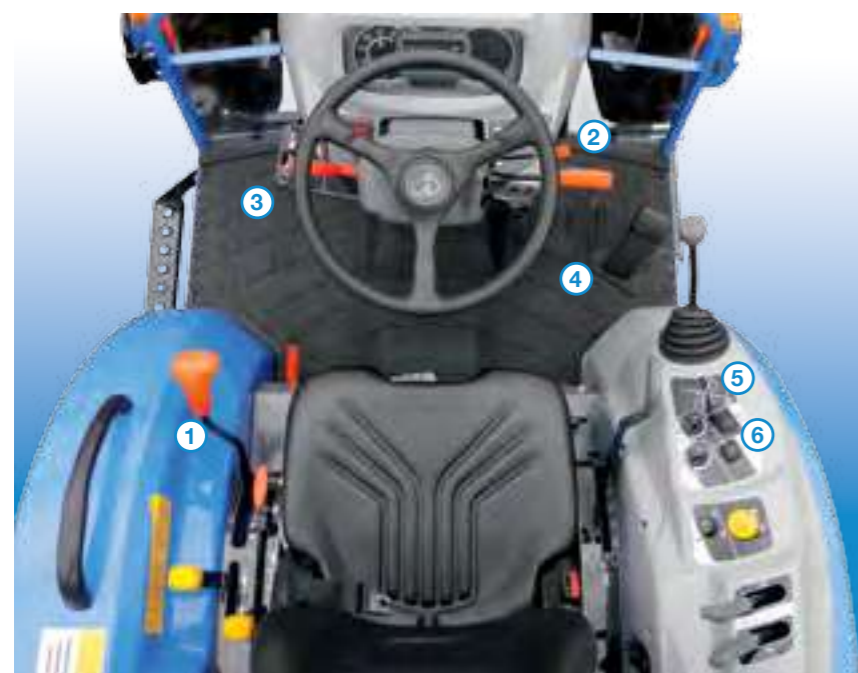
Levier de sélection de gamme de vitesses (1), commande Hi-Low (TG6490HST), inverseur de marche (3), pédale d'avancement (4), régulateur de vitesses (5), fonction mémoire de vitesse pour revenir à la vitesse initiale (6).
