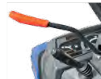
Inverseur de marche au volant Sur versions TM32 mécaniques
